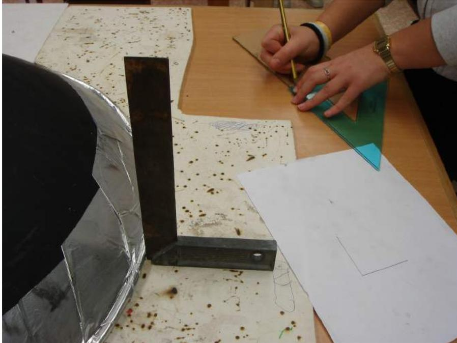
Calcolo sperimentale per l'inclinazione dei cunei di sostegno laterale della parabola
