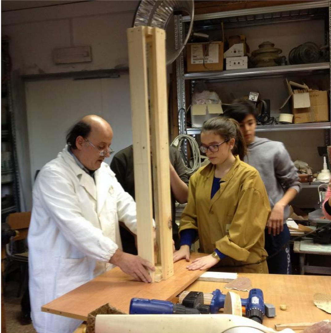
*5) Sempre utilizzando del legno, abbiamo ricavato delle assi con le quali abbiamo costruito un sistema di sostegno, la colonna, del nostro eolico, munita di una base ampia, per evitare rovesciamenti.*
