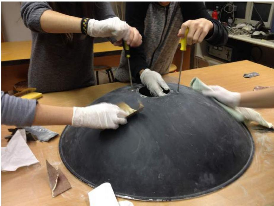
Successivamente abbiamo utilizzato la carta alluminata, tagliata a forma trapezoidale con misure differenti, per ricoprire la curvatura interna della parabola aiutandoci con la colla vinilica; questa carta serve inoltre a riflettere i raggi solari e l'abbiamo utilizzata anche per ricoprire il bordo della curva esterna della parabola.
