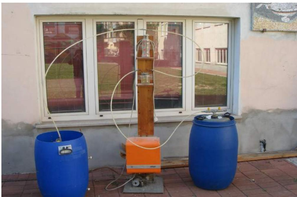
Abbiamo mescolato 50 litri di H<sub>2</sub>O, 5 kg di farina proteica e al tutto abbiamo aggiunto 300 g di batteri anaerobici in una tanica di p.v.c. che rappresenta il biodigestore.
