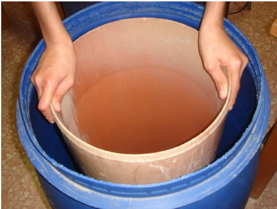
*Parte del gasometro che verrà riempita all'esterno con acqua (funzione guarnizione)*
