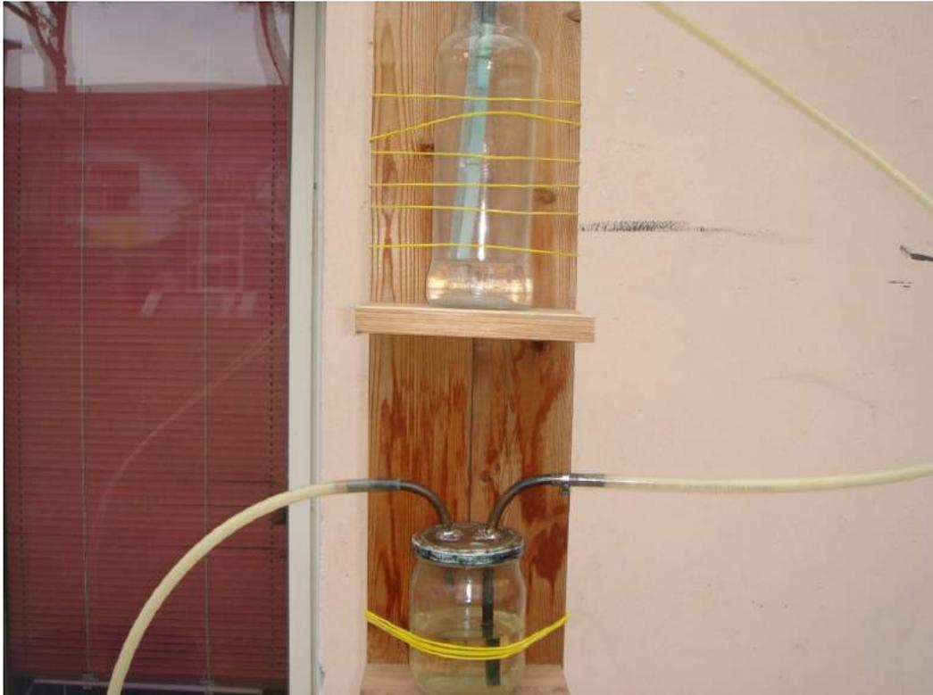
*Parte di controllo del digestore: in alto misuratore della pressione di uscita del gas con pallina galleggiante; in basso valvola di sicurezza antiritorno di fiamma.*
