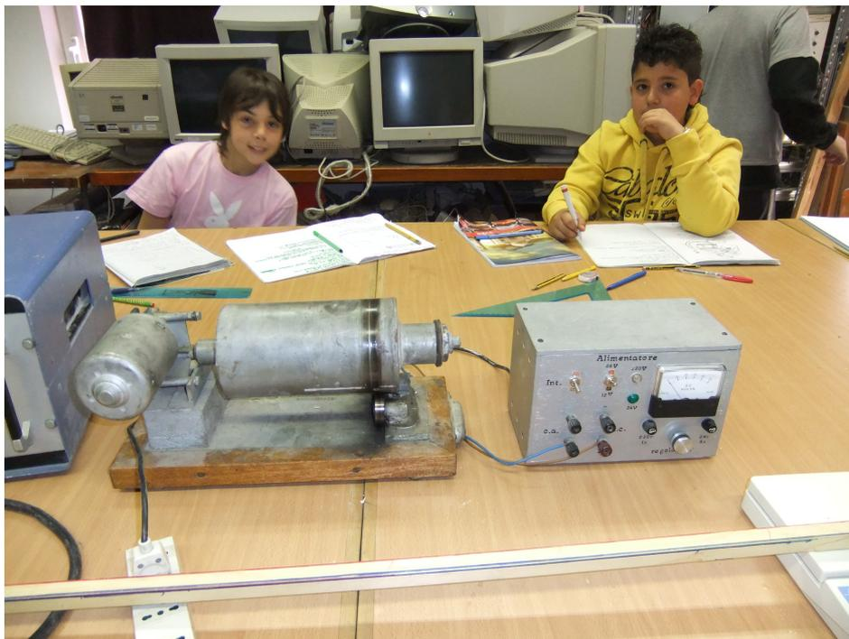
La barilatrice è una macchina che gira spinta da un motore di forma cilindrica,dove abbiamo messo tutti i materiali, dopo averli pesati:
