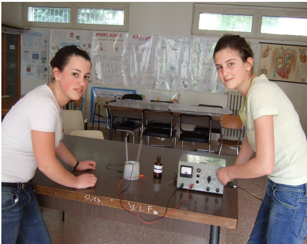
**Osservazioni:** appena si collega l'alimentatore si osservano delle bollicine che dagli elettrodi salgono verso l'alto all'interno delle provette, dopo un po' di tempo le provette iniziano a svuotarsi, in quella collegata al polo negativo lo svuotamento procede più velocemente.
