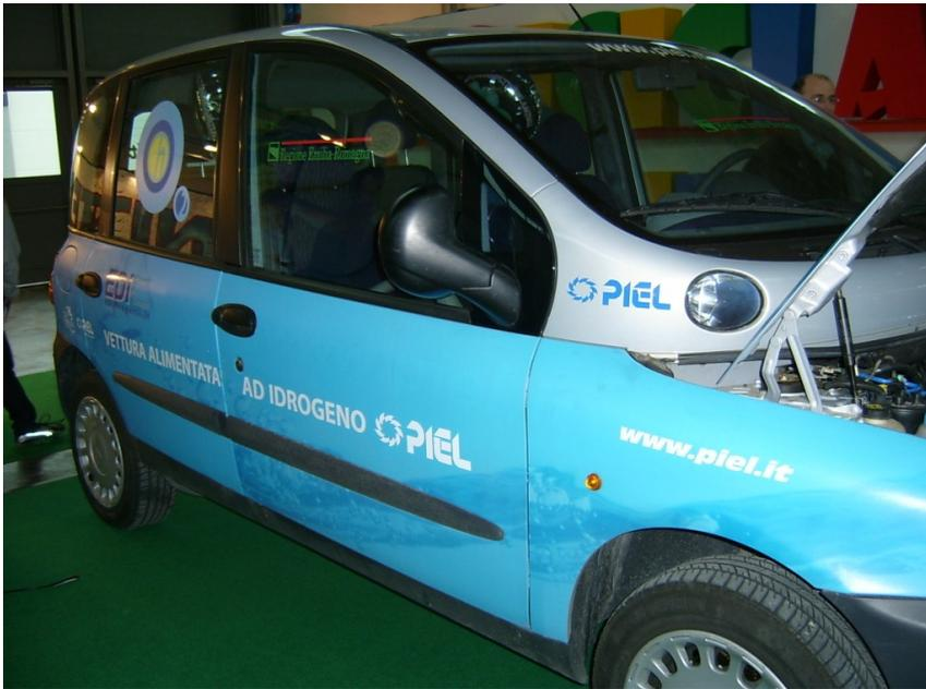
Fiat multipla funzionante con delle bombole ad idrogeno, sul tipo di quelle a metano
